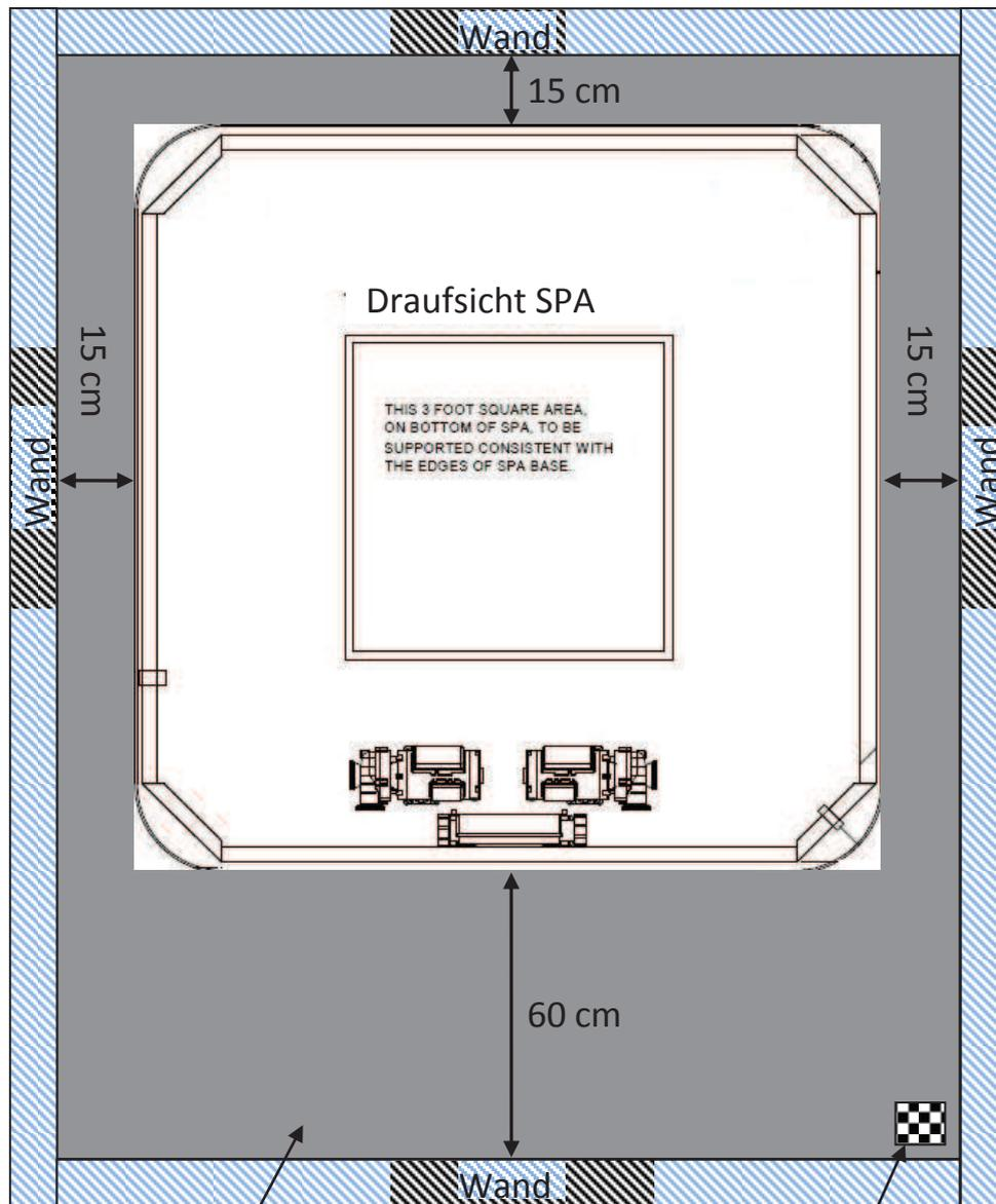
Revisionsbereich für Installation und Service, der graue Bereich muss zugänglich bleiben. Die Aussparung muss mindestens den Maßen auf der Skizze entsprechen.
