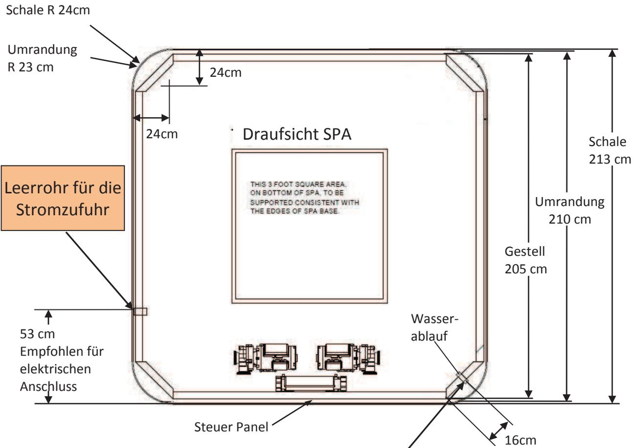
Entleerung Kugelhahn 3/4" Aussengewinde für Gartenschlauch
