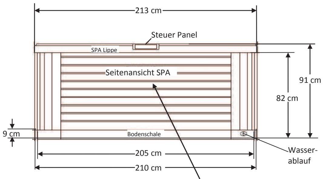
Diese Aussenseite des Whirlpools muss zugänglich und demontierbar sein. Die Technik befindet sich direkt hinter dieser Abdeckung.
