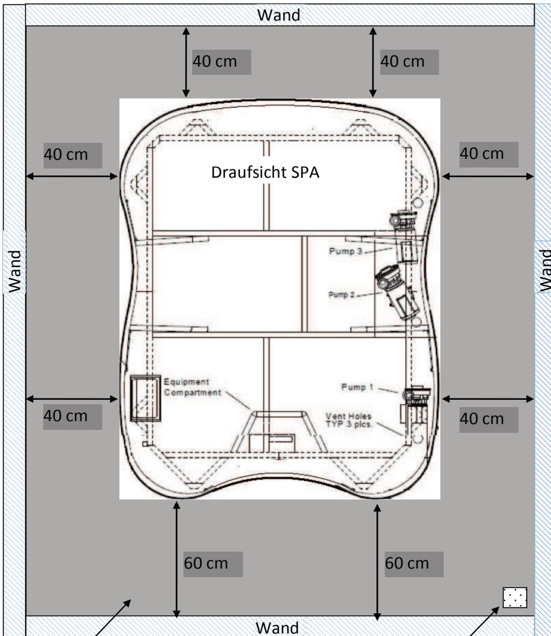
Revisionsbereich für Installation und Service, der graue Bereich muss zugänglich bleiben. Die Aussparung muss mindestens den Maßen auf der Skizze entsprechen.
