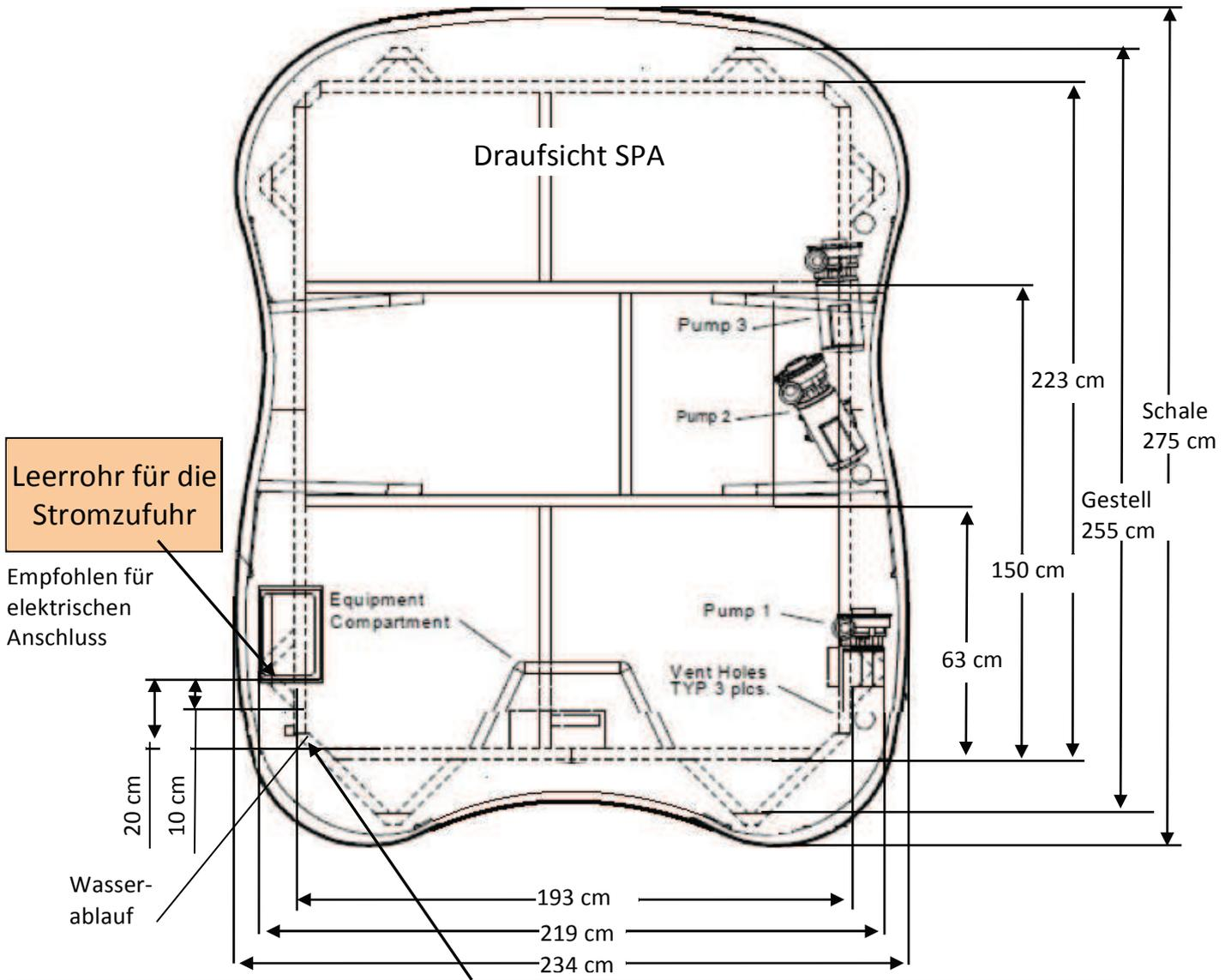
Entleerung Kugelhan3/4" Außengewinde für Gartenschlauch
