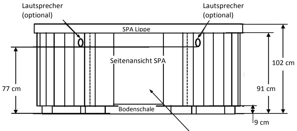
Diese Außenseite des Whirlpools muss zugänglich und demontierbar sein. Die Technik befindet sich direkt hinter dieser Abdeckung.
