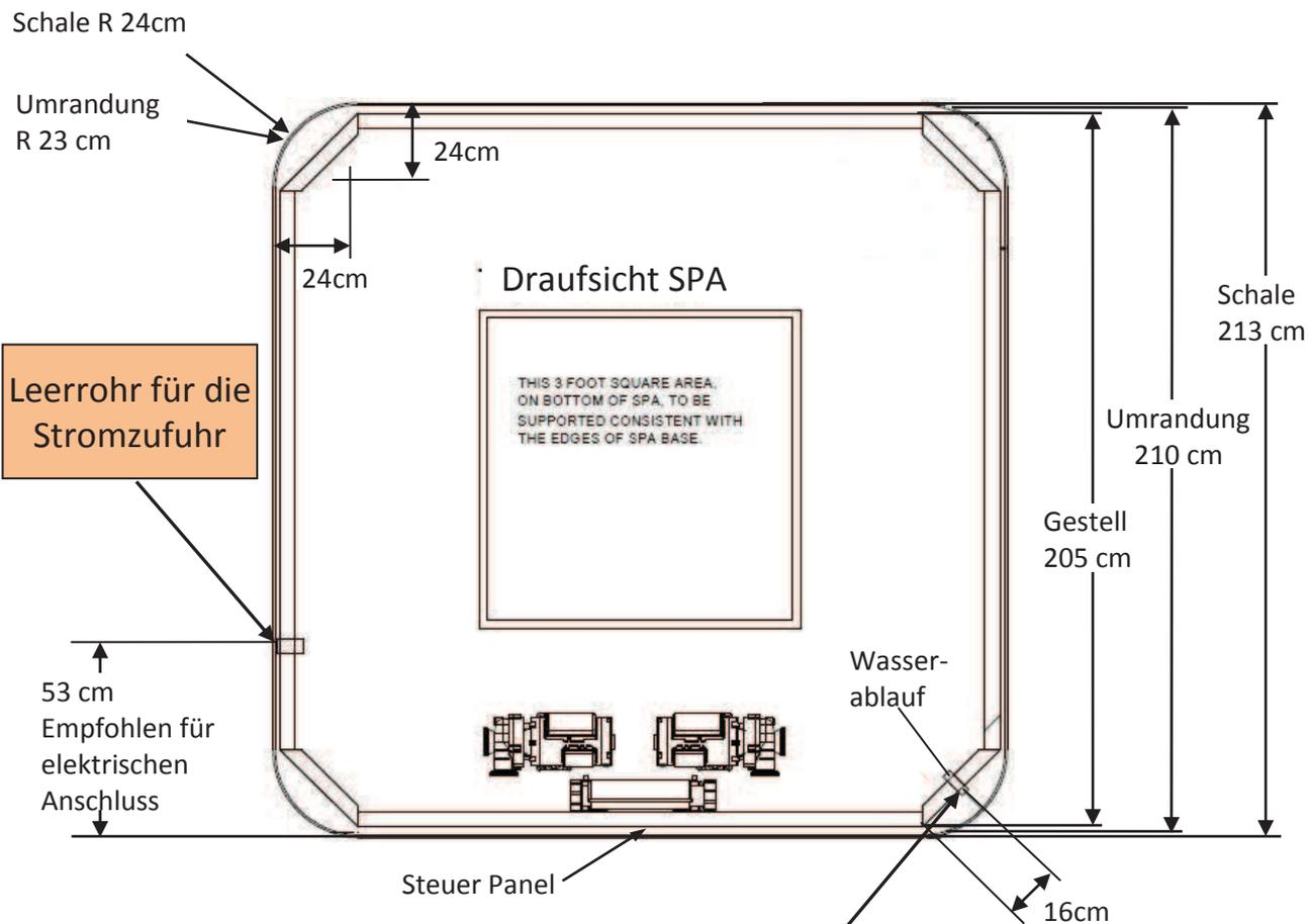
Entleerung Kugelhahn 3/4" Aussengewinde für Gartenschlauch
